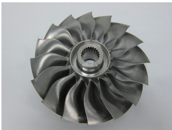
Fig. 6 Swept fan of small-scale rig
