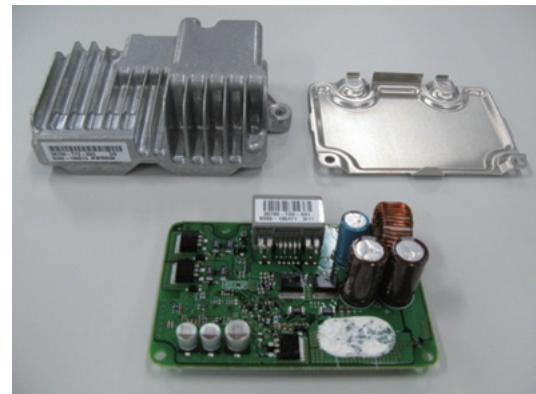
Fig. 10 Booster ACM ECU
