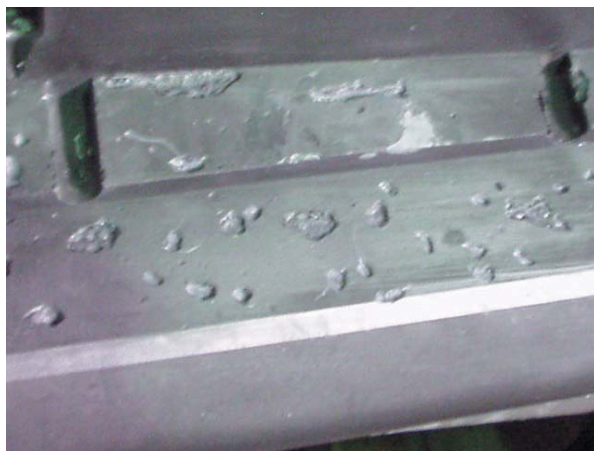
Fig. 5 Cave-in due to void
