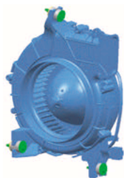
Fig. 20 IPU cooling fan
