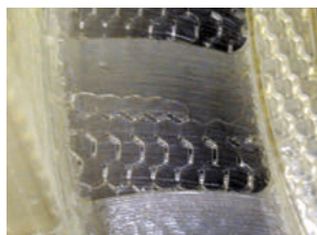
Fig. 16 Layer mark (SLA)
