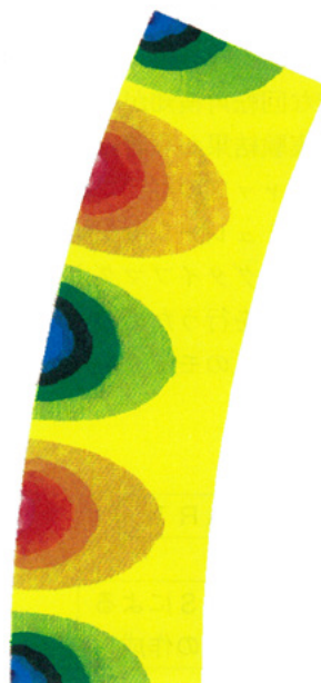
図6 マグネット部磁化率 ( r 方向成分) コンター図
