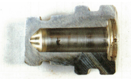
図13 インジェクタの摩耗
