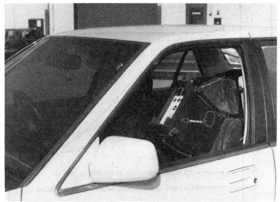
図2 前部助手席でのスピーチトランスミッションメータのトランスミッタ部 (Type4225) 設置の様子
