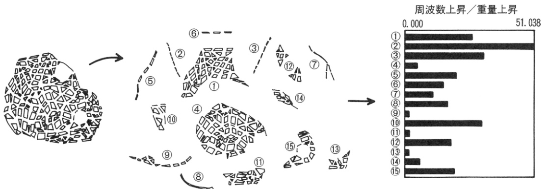
図 9 クラッチケース肉厚の設計感度解析例 (上下曲げモード)
