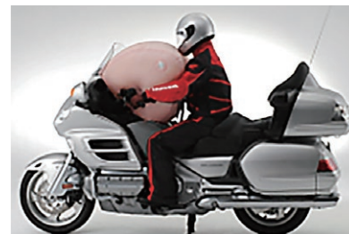
二輪車用エアバッグシステム
