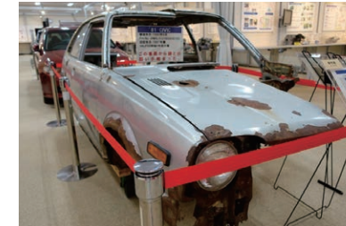
1981年製「シビック」の車体のさび
