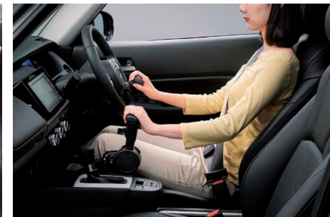
「Honda・テックマチックシステム」Dタイプ (手動運転補助装置) 装着例
