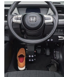
「Honda・フランツシステム」 (足動運転補助装置) 装着例
