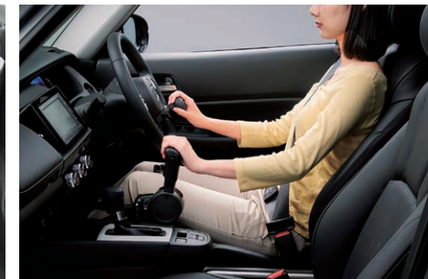
「Honda・テックマチックシステム」D タイプ （手動運転補助装置）装着例
