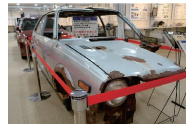
1981 年製「シビック」の車体のさび
