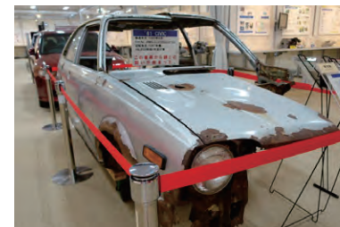
1981 年製「シビック」の車体のさび
