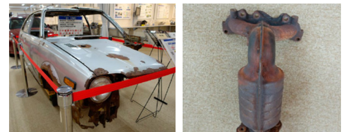
1981年製「シビック」の車体のさび / 1999年製「ライフ」排気マニホールドの割れ
