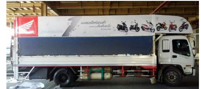
タイの二輪車輸送に用いられる天然ガストラック
