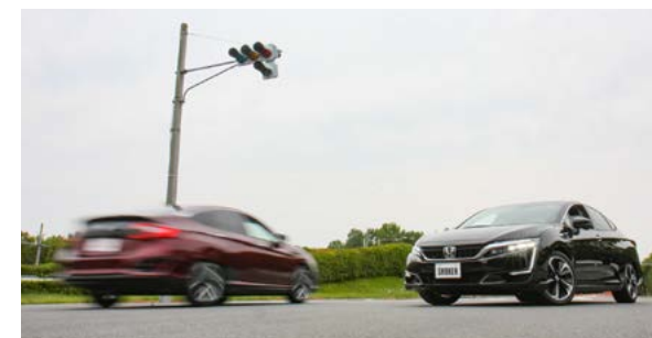
交差点を模したテストコースでの実車検証の様子
