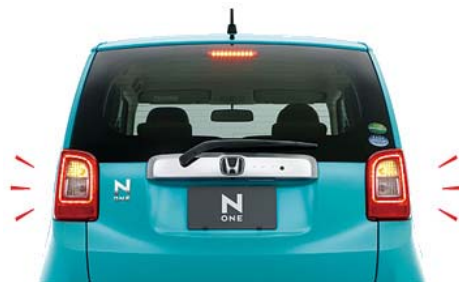
急ブレーキの際にハザードランプが自動で高速点滅する「エマージェンシーストップシグナル」
