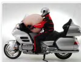
世界初となったHondaの二輪車用エアバッグシステム
