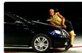
屋内型全方位衝突実験施設での「POLAR II」による衝突実験
