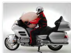
世界初となったHondaの二輪車用エアバッグシステム
