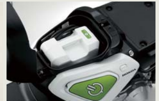
シートの下に収納できるコンパクトな普通充電器。スタートボタンを押すだけの簡単操作と45dBの静音設計が特長。
