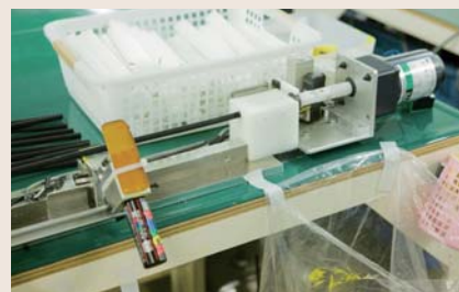
市販のペンを使って作業用の印を正しく確実につける工夫を施した「からくり改善」
