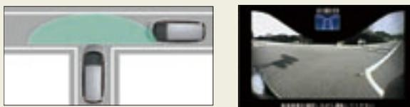
**幅寄せ支援** 幅寄せ、すり抜けなどの際の運転操作を支援
