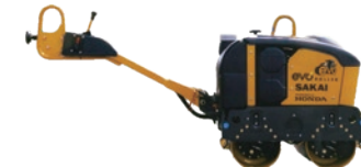
「eGX」搭載 酒井重工業株式会社 電動ハンドガイドローラ 「HV620 evo」
