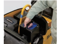
「eGX」搭載 酒井重工業株式会社 電動ハンドガイドローラ 「HV620 evo」
