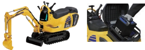
「Honda Mobile Power Pack e:」搭載 株式会社小松製作所の電動マイクロショベル「PC01E-1」
