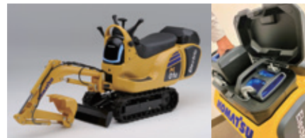
Hondaモバイルパワーパック (Mobile Power Pack) 搭載の コマツ社のマイクロシヨベルPC01E-1
