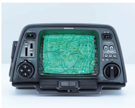
機能的にはジャンボジェットの「慣性航法装置」と同じで、高い精度の情報取得が行えた
