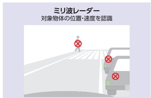
対象物体の位置や速度の検知に加えて、電波の反射率が低い歩行者も検知
