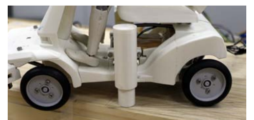
転倒リスクを検知すると射出される転倒防止バーがストッパーの役割を果たす
