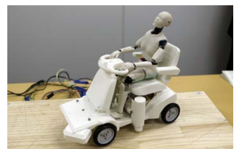
実際と同じ挙動をするように、模型とダミー人形の重心位置、慣性モーメントなどは実物を再現
