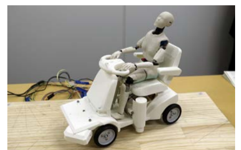
実際と同じ挙動をするように、模型とダミー人形の重心位置、慣性モーメントなどは実物を再現
