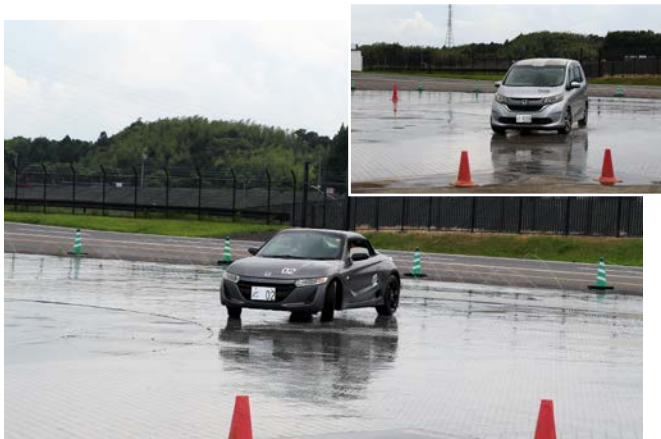
すべりやすい路面での安全運転を考えてもらうためのスキッド走行。カーブの途中、あえてアクセルを踏んで、後輪駆動と前輪駆動の挙動の違いを感じてもらう
