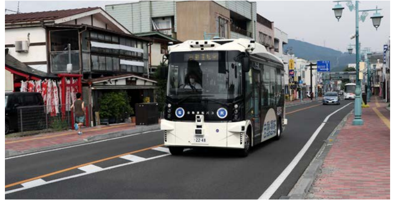
2025年度は5月からL2での自動運転バスの定常運行を隔週の金曜日と土曜日に実施している。車両はL4の車両認可を受けた「Minibus」を使用している。(株)ティアフォーの自動運行装置を搭載した全長7.19mのEVバスで、運転席、立ち席を含め23人乗り。約30個のセンサーやカメラを使い、車両自身が自分の位置を認識しながら最高35km/hで走ることができる
