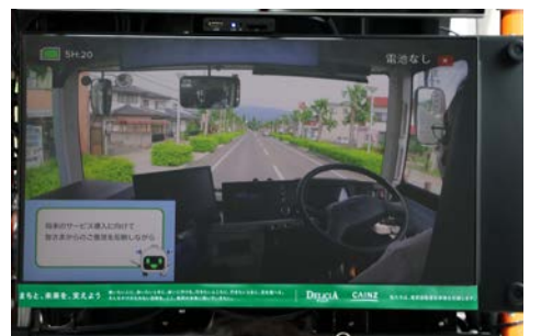
定常運行は運転士が乗車し、状況に応じて自動運転と手動運転を切り替えるL2での走行(車内のモニターで運転席の様子が客にわかるようになっている)
