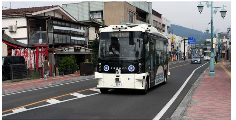
2025年度は5月からL2での自動運転バスの定常運行を隔週の金曜日と土曜日に実施している。車両はL4の車両認可を受けた「Minibus」を使用している。(株)ティアフォーの自動運行装置を搭載した全長7.19mのEVバスで、運転席、立ち席を含め23人乗り。約30個のセンサーやカメラを使い、車両自身が自分の位置を認識しながら最高35km/hで走ることができる
