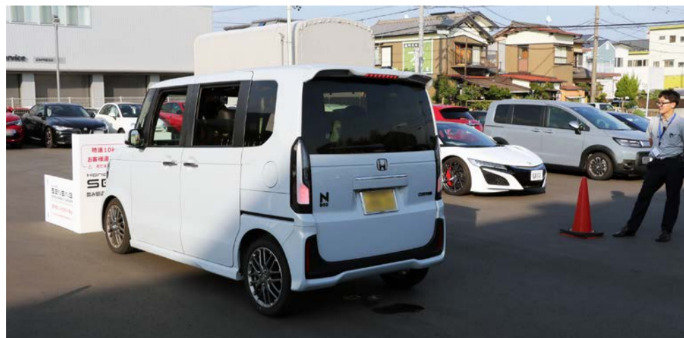
近距離用ターゲットを使って誤発進抑制機能と近距離衝突軽減ブレーキを体感
