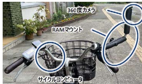
360度撮影できるカメラをはじめ、電動自転車に様々な計測機器を取り付け、生徒の運転行動を記録
