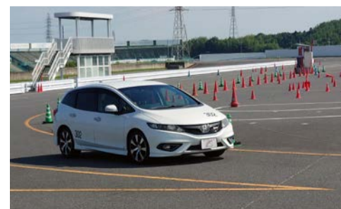
等速・加減速コーナリングではカーブの途中で車体が揺れないように、ハンドルの舵角を一定にすることを受講者に意識してもらう
