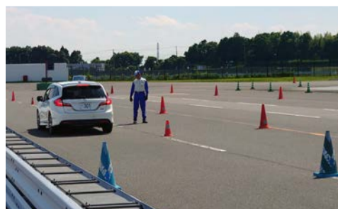
「ケアドライブ」の課題の一つ、ブレーキ。目標となる青いパイロンを通過したらブレーキペダルを踏む量を一定にしたまま停止させる
