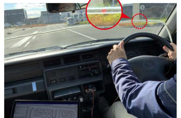
点灯したLEDランプ(写真赤丸部分)を発見した時に「はい」と発声すると、測定器がLEDランプの位置を記録
