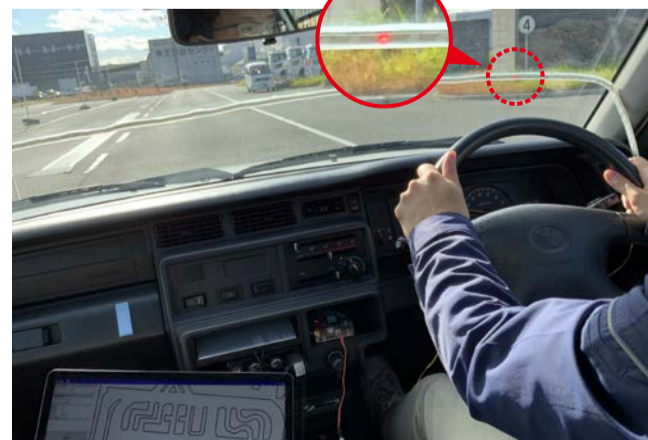
点灯したLEDランプ(写真赤丸部分)を発見した時に「はい」と発声すると、測定器がLEDランプの位置を記録
