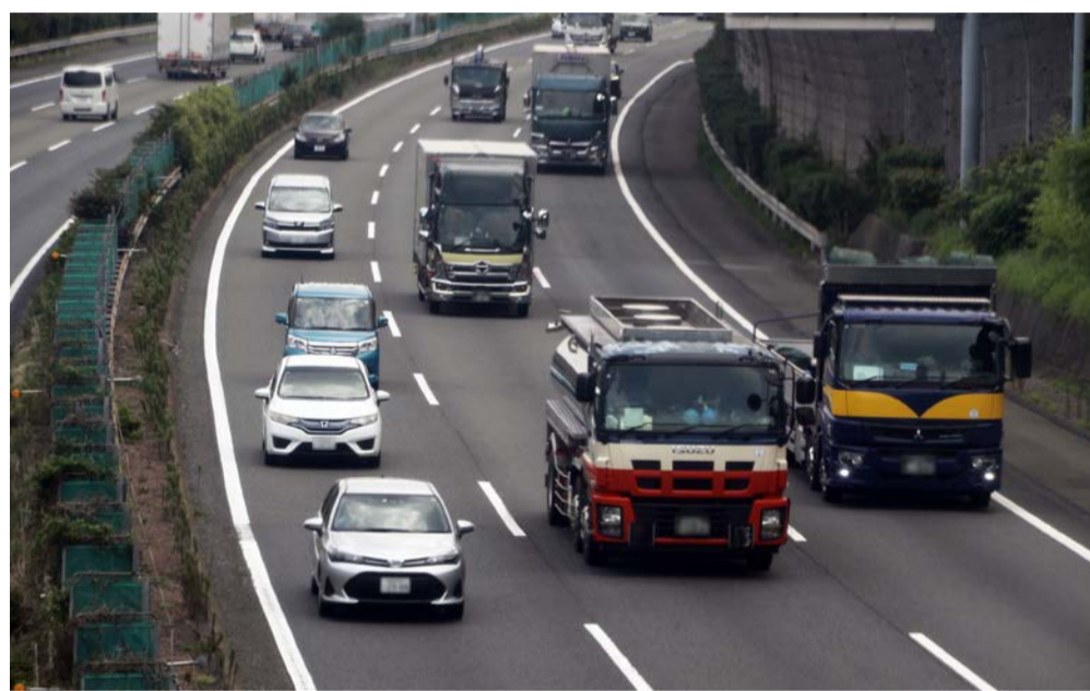
高速道路(観察場所A)では、追越車線の車列は他の2車線に比べ車間が詰まるが多かった
