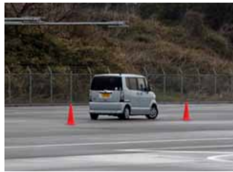
一定の速度を維持しながらパイロンスラロームを行う
