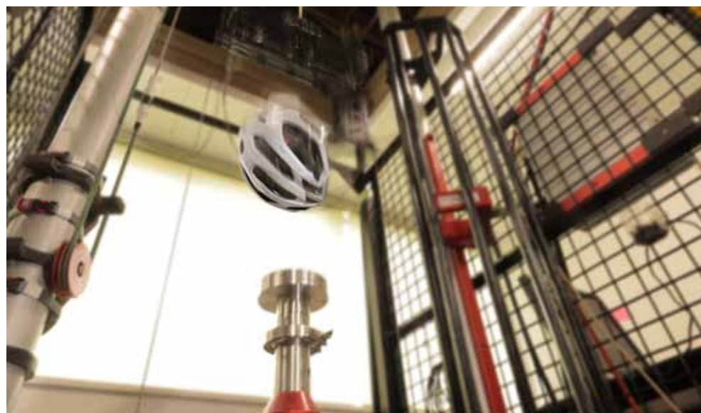
衝撃吸収試験の様子
