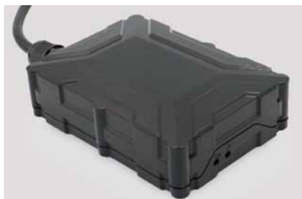
TCUという専用の車載通信機を取り付けることで、高精度な走行データを取得できる
