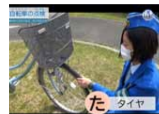
「自転車点検」ではブレーキやタイヤなど6つの点検項目について、指導員が手順を実演
