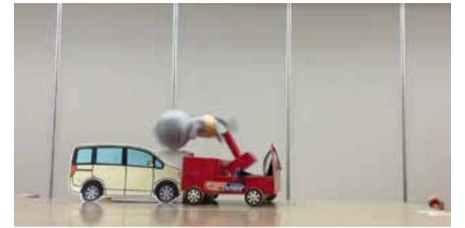
ベルトをしていない「できるニャン」は、衝突によって前方に勢いよく投げ出されてしまう
