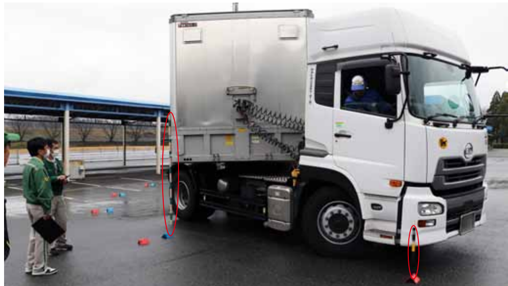
トラクターの右前方の角とトレーラーの右前方の角が通る軌跡を赤と青のマーカーで示す
