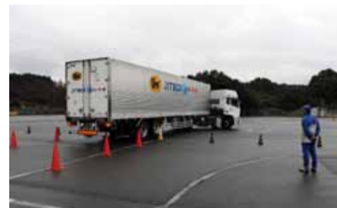
車庫入れの際も連結部で折れ曲がることを考慮して後退する
