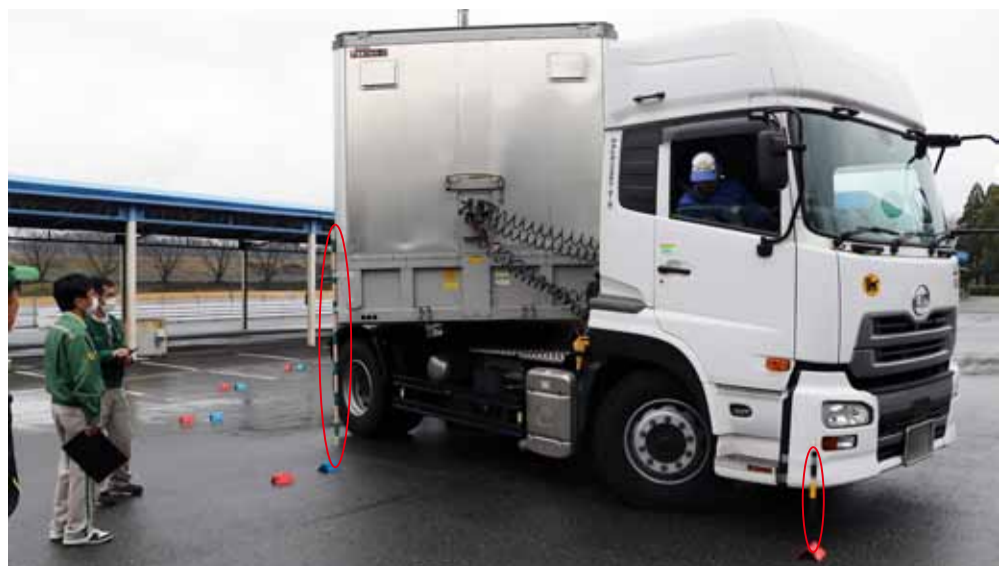
トラクターの右前方の角とトレーラーの右前方の角が通る軌跡を赤と青のマーカーで示す
