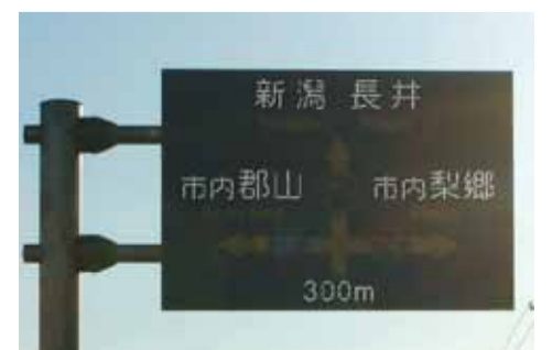
逆光現象対策標識（写真下）の採用によって判読性が大幅に改善された例
