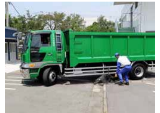
大型車の内輪差による左折巻き込み事故の再現
