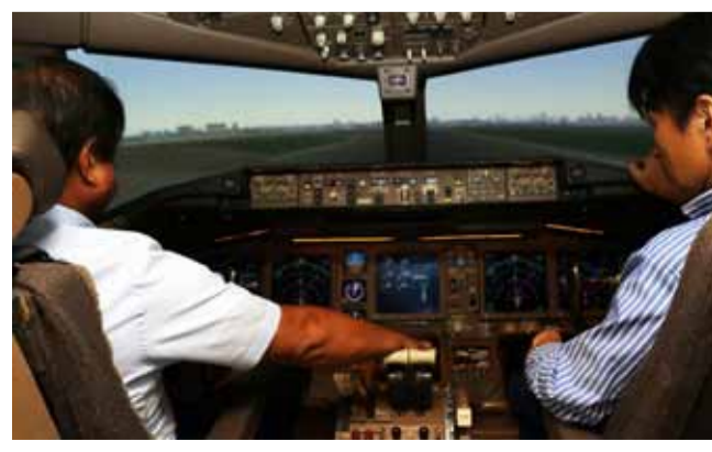
シミュレーターの内部。操縦に合わせて上下、左右と複雑に動き、視覚だけでなく、加速や機体の旋回など実機と変わらない飛行感覚が体感できるようになっている
