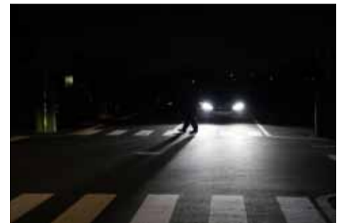
夜間にクルマ同士がすれ違う際、その間に位置する歩行者が見えなくなる蒸発現象を再現
