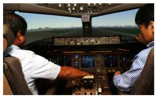
シミュレーターの内部。操縦に合わせて上下、左右と複雑に動き、視覚だけでなく、加速や機体の旋回など実機と変わらない飛行感覚が体感できるようになっている
