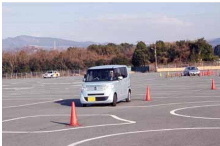
パイロンスラロームでは一定の速度を維持しながら適切なハンドル操作ができるかを確認
