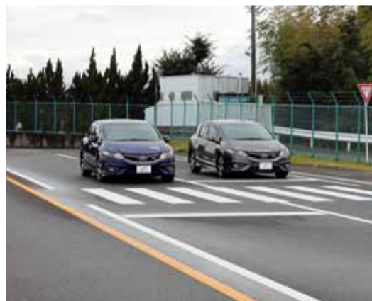
DSPシステムを搭載した車両を運転、指定されたコース（1周約800m）を走行。一時停止場所や急カーブ、上り下り、右左折、横断歩道の通過など9カ所のチェックポイントを通過
