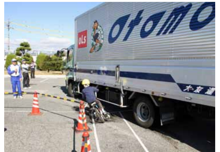
トラックの内輪差による左折巻き込み事故を再現
