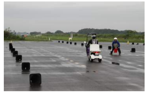
前方にある信号機の点灯を確認したらブレーキをかけて停止する反応制動
