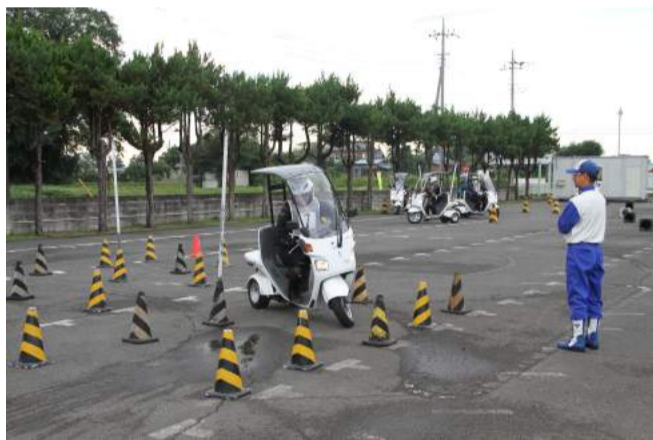
バランス訓練の様子。パイロンにはボールが立てられ、車体を傾けた時に屋根が接触しないようにすることも意識してもらう
