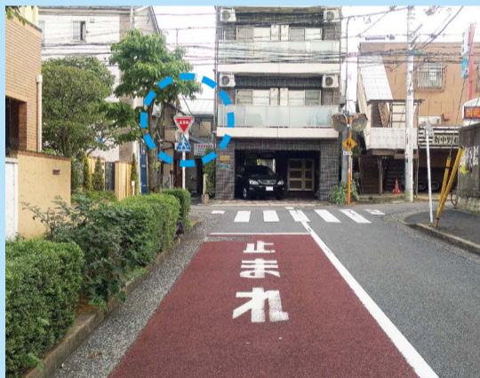
一時停止標識が街路樹によって隠れてしまい車両から認識しにくかったが、観察時は枝が伐採され見えやすくなっていた
